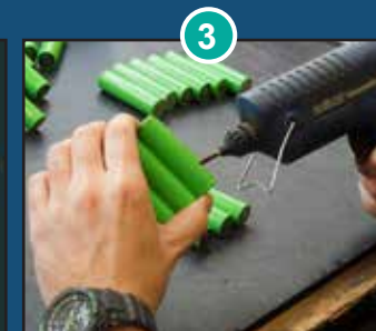
Assemblage des cellules
