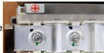
In industriellen und logistischen Anwendungen wird ausschließlich LiFePO<sub>4</sub> verwendet. Es ist wichtig zu wissen, dass diese Technologie sich nicht entzündet oder explodiert, selbst wenn die Batterie kaputt geht. Sie ist vollständig geschützt. Die Zellen werden in Modulen mit lasergeschweißten Stromschienen montiert. Durch diese Verbindung wird der Innenwiderstand reduziert und das Risiko schlechter Verbindungen verringert.
